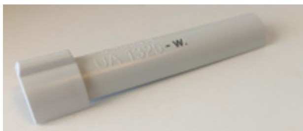
Рисунок 4. Пластмассовая крышка, расположенная вогнутой стороной вниз для обеспечения стекания жидкости во время автоматической обработки.
