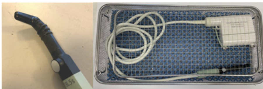
Рисунок 1-1. Датчик X18L5s (9009) с сочленением на наконечнике в нейтральном положении, зафиксированный в лотке мойки-дезинфектора.
